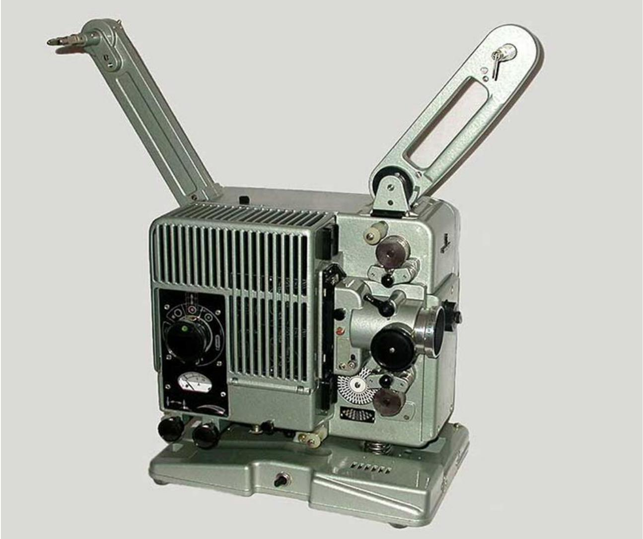
**Der SIEMENS-2000, das "Profimodell" für Schulen und kleine Kinos; gebaut Mitte der 50er Jahre. Schweres Gehäuse aus Metall (etwa 11 Kilogramm!), Geeignet für Lampen von 250 bis 1.000 (!) Watt.**
